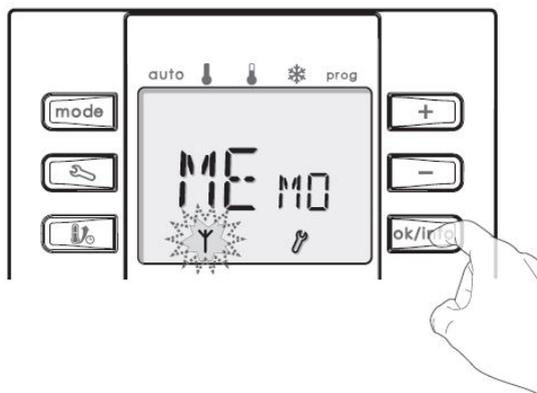
**Effacement du code mémorisé** : appui minimum de 15 secondes sur le bouton Mémo du récepteur.
